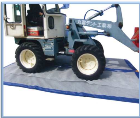
工場前にてタイヤに消毒液の吸着状態を試験中
